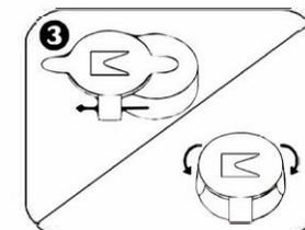
5 Vložte novú 1,5 V batériu AG13 kladnou stranou nadol a zatvorte kryt batérie.
