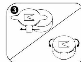
Vložte novou baterii AG13 1,5 V kladnou stranou dolů a zavřete kryt baterie.
