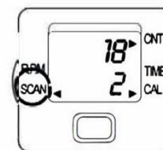
**SCAN:** Prepína hodnoty medzi ( TIME >CNT>RPM>CAL).
