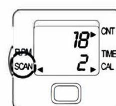
**SCAN:** Przełącza wartości pomiędzy ( TIME >CNT>RPM>CAL).
