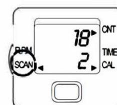
**SCAN:** Az értékek közötti váltás ( TIME >CNT>RPM>CAL).
