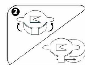
Z tyłu konsoli podnieś osłonę baterii i wyśnij baterię.
