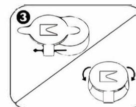
Włóż nową baterię 1,5 V AG13, dodatnią stroną do dołu i zamknij osłonę baterii.
