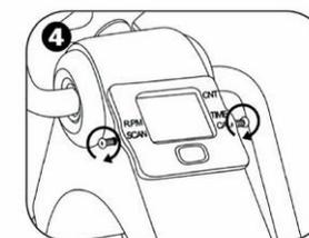
Umieść konsolę w obudowie i zabezpiecz jej położenie poprzez dokręcenie śrub z obu stron.
